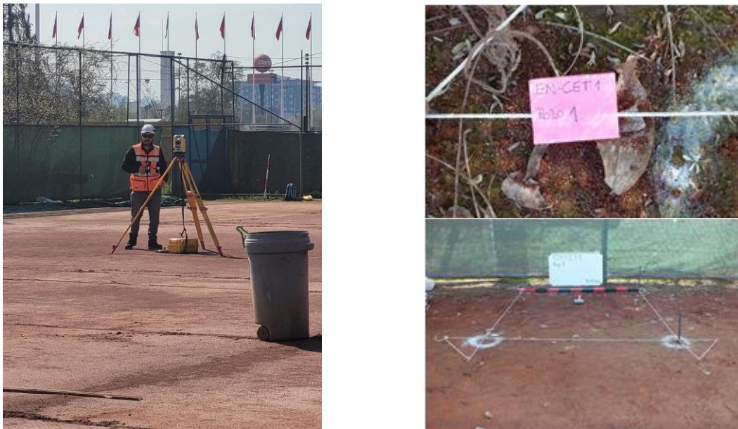
Fig. 10 a 12. Trazado topográfico de los pozos de caracterización arqueológica.
