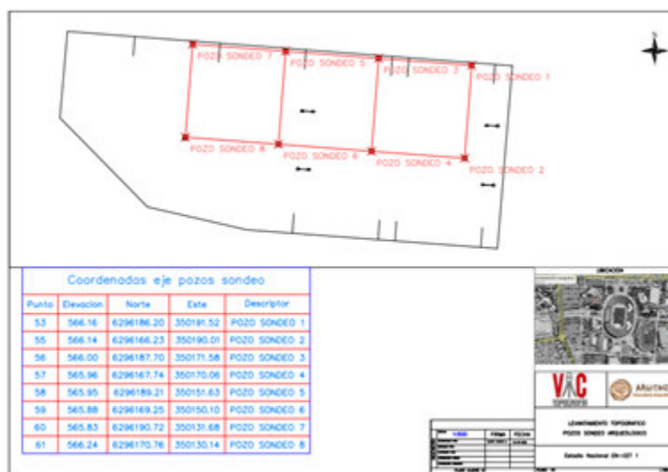
Fig. 8. Levantamiento topográfico de los 8 pozos de caracterización arqueológica.
